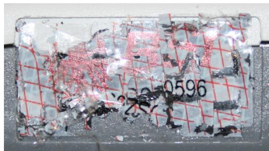
Abbildung 3: Beschädigtes Gehäusesiegel
