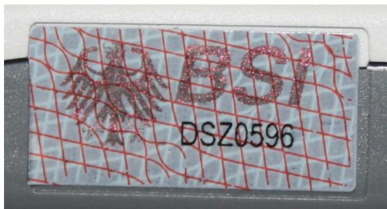
Abbildung 2: Unbeschädigtes Gehäusesiegel
